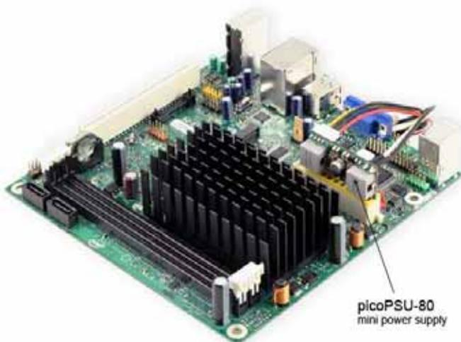
2) Schließen Sie einen 12 VDC AC Adapter (oder eine andere 12 V Quelle) am DC-to-DC Stecker an. (der Pin in der Mitte / das weiße Kabel ist +12V (Plus)
